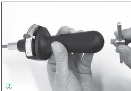
Při dosažení požadované měřené hodnoty musí být dobře vidět stupnice a značka ručičky (při měřeních s vlečnou ručkou to není důležité).
