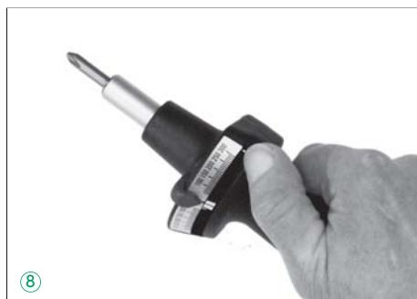
b) Aseta TORSIOMETER paikalleen ja kierrä kahavasta haluttuun lukemaan asti (palautettava maksimiosoitin siirtyy mittausosoittimen mukana) ⑨. Kun torsiometri ei enää kuormiteta, palautettava
