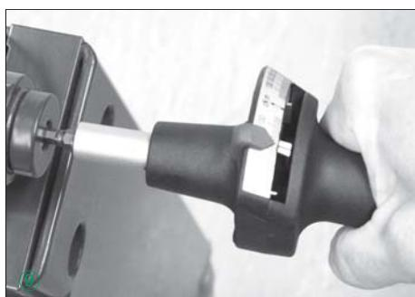
**4.4** Indicación de un valor de par de giro memorizado en pulgadas.lb (sólo en caso de accionamiento a la derecha):
