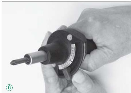
c) TORSIOMETER ansetzen und betätigen (s. 3.), bis Zeigermarke die Messspitze des Schiebereiters erreicht ⑦.
