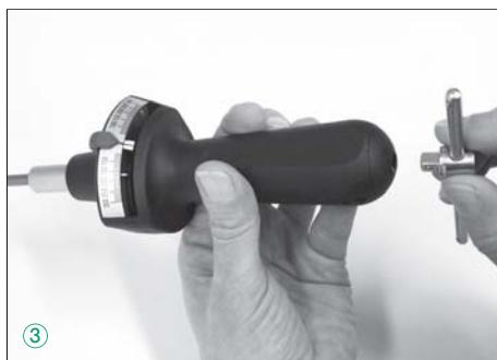
Effettuare il procedimento di serraggio in modo regolare, nell'ultima fase senza interruzioni, fino al valore di misurazione. Per i momenti di torsione maggiori, si può inserire alla fine dell'impugnatura un utensile ausiliario con quadrato esterno di 1/4", ottenendo così una trasmissione migliore della forza (p. es. impugnatura trasversale n. 404) ③.
