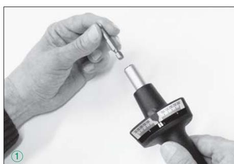
sześciokątnym  $\frac{1}{4}$ " o kształcie E 6,3 zg. z DIN 3126. Dotyczy to zarówno wymiennych końcówek narzędziowych do bezpośredniego kontaktu z połączeniem śrubowym (A), jak również elementów pośrednich do łączenia z innymi bitami i końcówkami (B).
