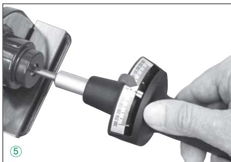
c) Helyezze fel a TORSIOMETER egységet és hozza működésbe (ld. 3.), amíg a mutatójelző el nem éri a kívánt értéket **(5)**.
