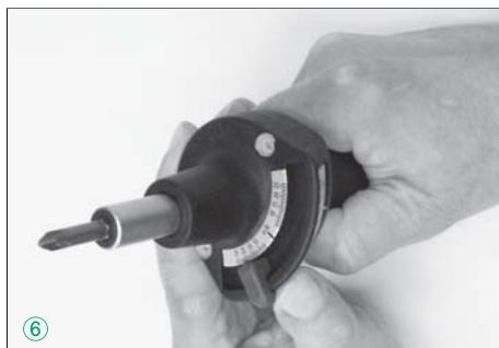
c) TORSIOMETER nasadte na skrutku a uťahujte (pozri odstavec 3), kým značka ukazovateľa nedosiahne merací hrot jazdca **(7)**.
