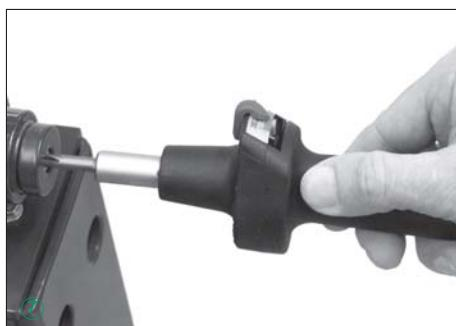
**4.3** Speicherung eines aufgebrachten Drehmomentwertes in cNm (nur bei Rechtsbetätigung):
