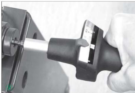
在取消施加的力之后，拖动指针测标将位于此前达到的刻度值的下方⑩。
