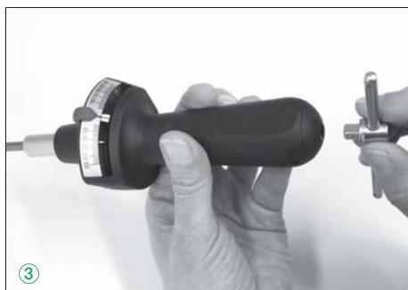
**Obs!** Visaren kan i obelastat läge stå något vid sidan av (0) noll, detta har inget inflytande på noggransenheten. När Du byter dragriktning, vrid till max belastning 1 gång innan mätning.
