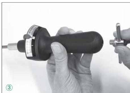
Le cadran et le repère de l'aiguille doivent être dans le champ de vision lorsqu'on atteint la valeur de mesure souhaitée (cela est sans importance pour les mesures avec aiguille entraînée).
