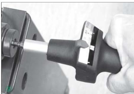
c) Pred ďalším použitím posuňte posuvný ukazovateľ znova do východiskovej polohy (pozri odstavec 4.3a).
