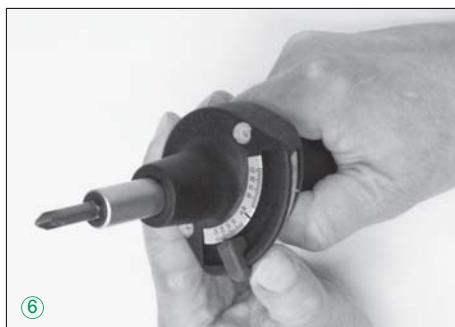
c) Aseta TORSIOMETER paikalleen ja kierrä kahvasta (ks.3.) kunnes osoitinmerkki saavuttaa liukuratsastajan mittauskärjen ⑦.
