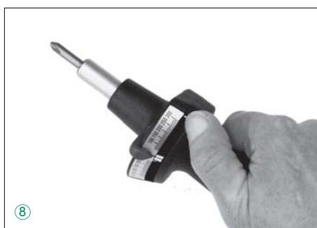
b) Helyezze fel a TORSIOMETER egységet (ld. 3) és hozza működésbe, amíg a kívánt hatást el nem éri (az eltolható mutatót a mérő mutató magával együtt mozgatja) **(9)**.
