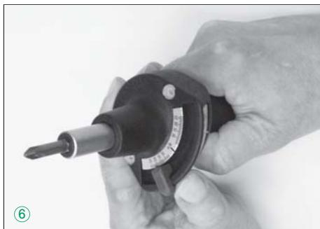
b) Spostare il corsoio rosso con la punta di posizionamento superiore sopra il valore desiderato sulla scala di riferimento inch.lb **⑥**.
