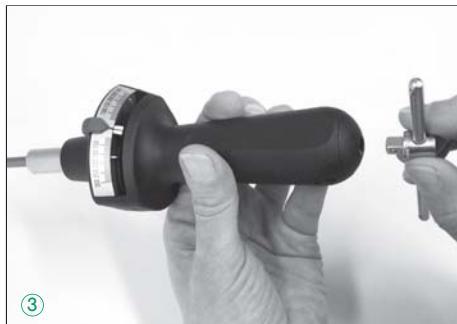
**ACHTUNG!** Die Zeigermarke kann in unbelastetem Zustand etwas neben „0“ stehen. Dies hat keinen Einfluss auf die Genauigkeit. Bei Wechsel der Anziehrichtung: Vor Messung einmal bis ca. Größtwert vorbelasten.
