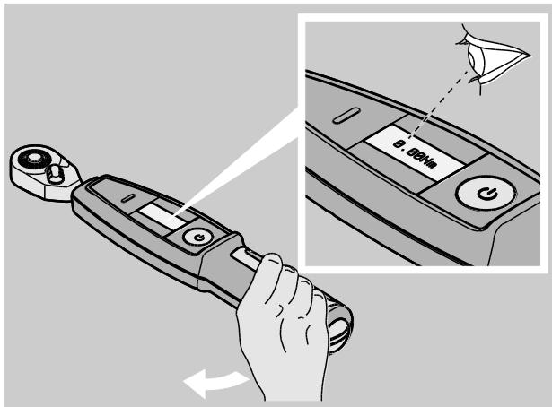
Während des Schraubvorgangs im Funktionsmodus „Track“ werden Ihnen je nach vorgenommenen Einstellungen folgende Anzeigen und Signale gegeben:
